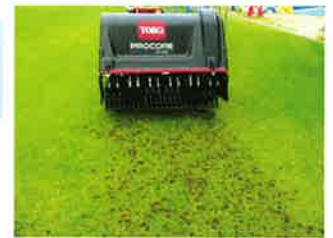
エアレーション作業
